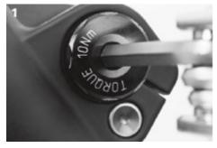
1. 推入筒轴, 用 6mm 内六 角扳手以 10Nm 的力将其 拧紧。
