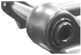
3. 检查筒轴螺纹。螺纹必须清晰可见。
