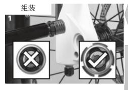
1. 在安装前要检查 分段法兰的展开 并完全打开手柄。
