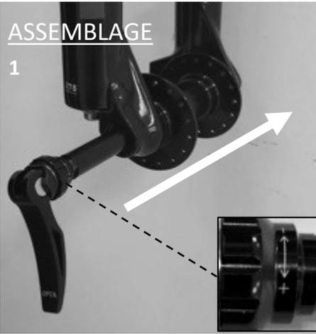
1. Après avoir tourné l'écrou de réglage vers le "+" jusqu'en butée, placez le moyeux de roue dans la fourche et insérez l'axe avec le levier en position ouverte.
