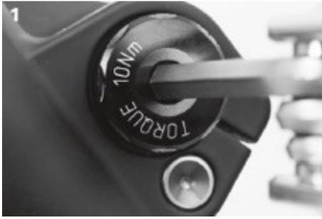
1. Insérez l'axe et serrez-le à 10Nm avec une clé Allen 6mm.
