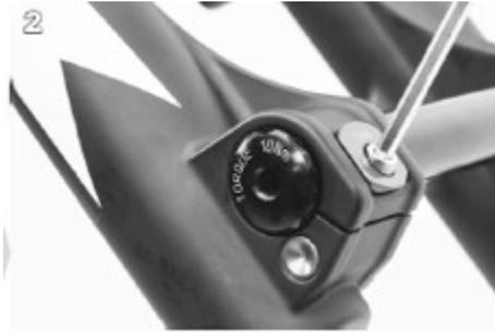
2. Serrez la vis de sécurité à 7Nm avec une clé Allen de 4mm.
