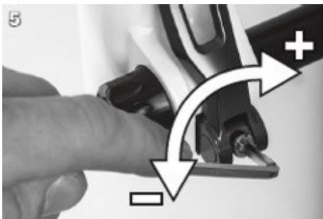
5. Ajustez le couple de serrage à l'aide d'une clé Allen de 4 mm, si nécessaire.
