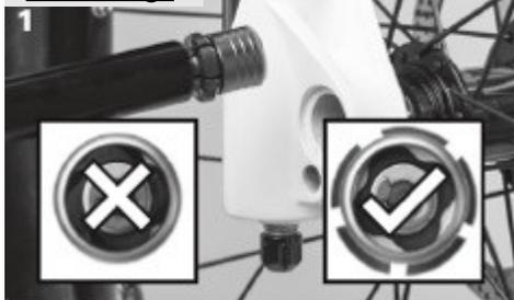
1. Vérifiez que les ailettes soient déployées avant l'installation et ouvrez complètement le levier.
