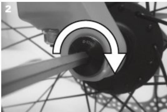
2. Serrez l'axe avec une clé Allen de 6mm au couple de serrage suggéré de 8-10Nm.
