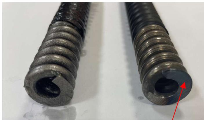
An beiden Enden der Feder des gefälschten Die Buchse des gefälschten Produkts ist ohne Rillen
