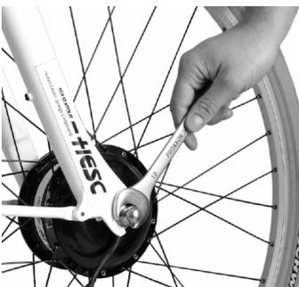
3. Lösen Sie die Muttern mit einem 19 mm Gabelschlüssel
