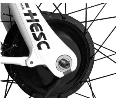
4. Entfernen Sie die Unterlegscheibe, die die Achse sichert
