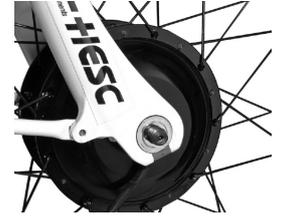
4. Entfernen Sie die Unterlegscheibe, die die Achse sichert
