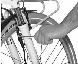
1. Entfernen Sie mit einem 4 mm Innensechskantschlüssel die Kabelführung.
