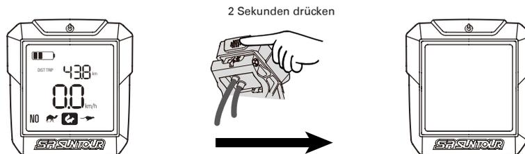
Das Display schaltet nach 10 Minuten automatisch aus, sofern keiner der unten aufgeführten Vorgänge ausgeführt wird:
