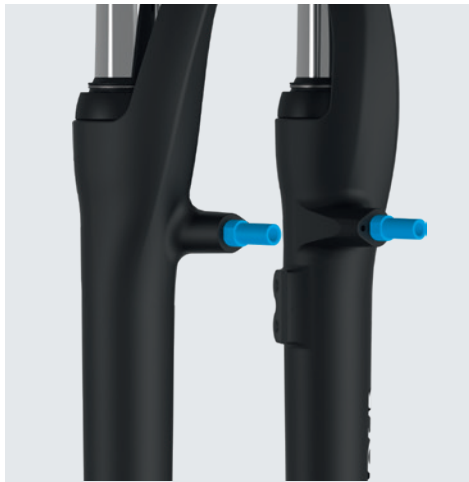
P PIVOT BRAKE TYPE AKA. V-BRAKE
